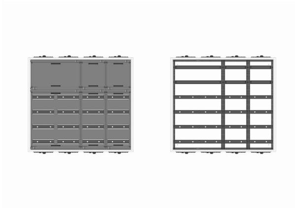
AVB4-6-210-S Automatenverteiler, AVB, BxHxT = 1050x950x210 Schutzklasse I, IP41, RAL 9016, Aufputz
