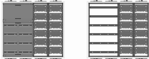
AVB4-6-210-M2 Automatenverteiler, AVB, BxHxT = 1050x950x210 Schutzklasse I, IP41, RAL 9016, Aufputz
