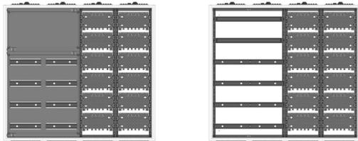
AVB4-6-210-M2-PAutomatenverteiler, AVB, BxHxT = 1050x950x210Schutzklasse I, IP41, RAL 9016, AufputzBestehend aus:Gehäuse, Doppeltür mit Drehriegel, Flansche NF1 (oben) und NF2 (unten), 1x Geräteträger 2-Feld breit 2/4 mit Feldabdeckungen PS, 1x Montageplatte 2-Feld breit
