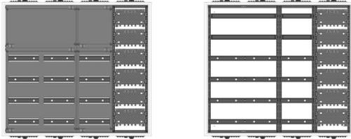
AVB4-6-210-M1-PAutomatenverteiler, AVB, BxHxT = 1050x950x210Schutzklasse I, IP41, RAL 9016, AufputzBestehend aus:Gehäuse, Doppeltür mit Drehriegel, Flansche NF1 (oben) und NF2 (unten), 1x Geräteträger 2-Feld breit 2/4 mit Feldabdeckungen PS, 1x Geräteträger 1-Feld breit 2/4 mit Feldabdeckungen PS, 1x Montageplatte 1-Feld breit
