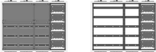
AVB4-5-230-M1-PAutomatenverteiler, AVB, BxHxT = 1050x800x230Schutzklasse I, IP54, RAL 7035, AufputzBestehend aus:Gehäuse, Doppeltür mit Schwenkhebel für PHZ, Flansche SF45 (oben) und SF41 (unten), 1x Geräteträger 2-Feld breit 2/3 mit Feldabdeckungen PS, 1x Geräteträger 1-Feld breit 2/3 mit Feldabdeckungen PS, 1x Montageplatte 1-Feld breit
