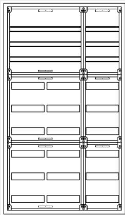
AVB3-9-230-S-PAutomatenverteiler, AVB, BxHxT = 800x1400x230Schutzklasse I, IP54, RAL 7035, AufputzBestehend aus:Gehäuse, Einzeltür mit Schwenkhebel für PHZ, Flansche SF45 (oben) und SF41 (unten), 1x Geräteträger 2-Feld breit 3/6 mit Feldabdeckungen PS, 1x Geräteträger 1-Feld breit 3/6 mit Feldabdeckungen PS
