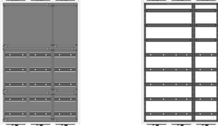
AVB3-8-210-S-PAutomatenverteiler, AVB, BxHxT = 800x1250x210Schutzklasse I, IP41, RAL 9016, AufputzBestehend aus:Gehäuse, Doppeltür mit Drehriegel, Flansche NF1 (oben) und NF2 (unten), 1x Geräteträger 2-Feld breit 3/5 mit Feldabdeckungen PS, 1x Geräteträger 1-Feld breit 3/5 mit Feldabdeckungen PS
