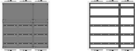
AVB3-5-210-S-PAutomatenverteiler, AVB, BxHxT = 800x800x210Schutzklasse I, IP41, RAL 9016, AufputzBestehend aus:Gehäuse, Doppeltür mit Drehriegel, Flansche NF1 (oben) und NF2 (unten), 1x Geräteträger 2-Feld breit 2/3 mit Feldabdeckungen PS, 1x Geräteträger 1-Feld breit 2/3 mit Feldabdeckungen PS
