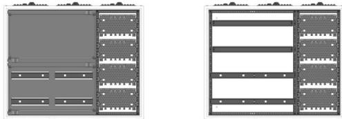
AVB3-4-210-M1-PAutomatenverteiler, AVB, BxHxT = 800x650x210Schutzklasse I, IP41, RAL 9016, AufputzBestehend aus:Gehäuse, Doppeltür mit Drehriegel, Flansche NF1 (oben) und NF2 (unten), 1x Geräteträger 2-Feld breit 2/2 mit Feldabdeckungen PS, 1x Montageplatte 1-Feld breit
