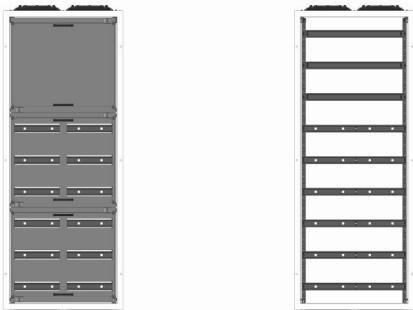
AVB2-9-400 Automatenverteiler, AVB, BxHxT = 570x1420x400 Schutzklasse I, IP54, RAL 7035, Aufputz Bestehend aus: Gehäuse, Einzeltür mit Schwenkhebel für PHZ, Flansche SF35 (oben) und SF32 (unten), 1x Geräteträger 2-Feld breit 3/6 mit Feldabdeckungen PRL
