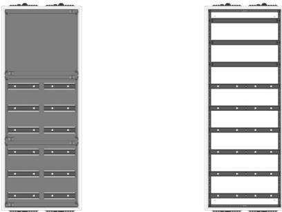
AVB2-9-210-PAutomatenverteiler, AVB, BxHxT = 550x1400x210Schutzklasse I, IP41, RAL 9016, AufputzBestehend aus:Gehäuse, Einzeltür mit Drehriegel, Flansche NF1 (oben) und NF2 (unten), 1x Geräteträger 2-Feld breit 3/6 mit Feldabdeckungen PS
