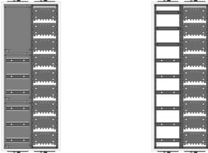
AVB2-9-210-M1-PAutomatenverteiler, AVB, BxHxT = 550x1400x210Schutzklasse I, IP41, RAL 9016, AufputzBestehend aus:Gehäuse, Einzeltür mit Drehriegel, Flansche NF1 (oben) und NF2 (unten), 1x Geräteträger 1-Feld breit 3/6 mit Feldabdeckungen PS, 1x Montageplatte 1-Feld breit
