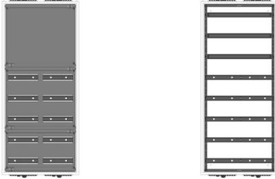
AVB2-8-230-PAutomatenverteiler, AVB, BxHxT = 550x1250x230Schutzklasse I, IP54, RAL 7035, AufputzBestehend aus:Gehäuse, Einzeltür mit Schwenkhebel für PHZ, Flansche SF45 (oben) und SF41 (unten), 1x Geräteträger 2-Feld breit 3/5 mit Feldabdeckungen PS
