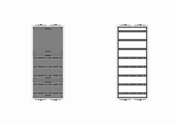
AVB2-8-210 Automatenverteiler, AVB, BxHxT = 550x1250x210 Schutzklasse I, IP41, RAL 9016, Aufputz
