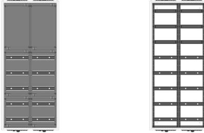
AVB2-8-210-S-PAutomatenverteiler, AVB, BxHxT = 550x1250x210Schutzklasse I, IP41, RAL 9016, AufputzBestehend aus:Gehäuse, Einzeltür mit Drehriegel, Flansche NF1 (oben) und NF2 (unten), 2x Geräteträger 1-Feld breit 3/5 mit Feldabdeckungen PS
