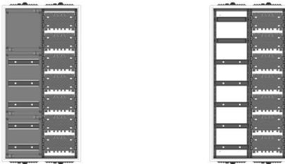
AVB2-7-230-M1-PAutomatenverteiler, AVB, BxHxT = 550x1100x230Schutzklasse I, IP54, RAL 7035, AufputzBestehend aus:Gehäuse, Einzeltür mit Schwenkhebel für PHZ, Flansche SF45 (oben) und SF41 (unten), 1x Geräteträger 1-Feld breit 2/5 mit Feldabdeckungen PS, 1x Montageplatte 1-Feld breit
