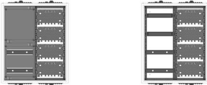
AVB2-4-210-M1-PAutomatenverteiler, AVB, BxHxT = 550x650x210Schutzklasse I, IP41, RAL 9016, AufputzBestehend aus:Gehäuse, Einzeltür mit Drehriegel, Flansche NF1 (oben) und NF2 (unten), 1x Geräteträger 1-Feld breit 2/2 mit Feldabdeckungen PS, 1x Montageplatte 1-Feld breit
