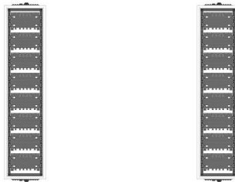
AVB1-8-230-M1 Automatenverteiler, AVB, BxHxT = 300x1250x230 Schutzklasse I, IP54, RAL 7035, Aufputz Bestehend aus: Gehäuse, Einzeltür mit Schwenkhebel für PHZ, Flansche SF45 (oben) und SF41 (unten), 1x Montageplatte 1-Feld breit
