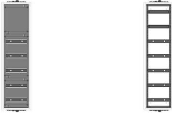
AVB1-7-230-PAutomatenverteiler, AVB, BxHxT = 300x1100x230Schutzklasse I, IP54, RAL 7035, AufputzBestehend aus:Gehäuse, Einzeltür mit Schwenkhebel für PHZ, Flansche SF45 (oben) und SF41 (unten), 1x Geräteträger 1-Feld breit 2/5 mit Feldabdeckungen PS
