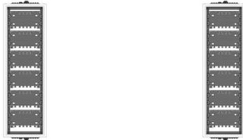
AVB1-6-210-M1 Automatenverteiler, AVB, BxHxT = 300x950x210 Schutzklasse I, IP41, RAL 9016, Aufputz
