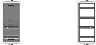
AVB1-4-230 Automatenverteiler, AVB, BxHxT = 300x650x230 Schutzklasse I, IP54, RAL 7035, Aufputz
