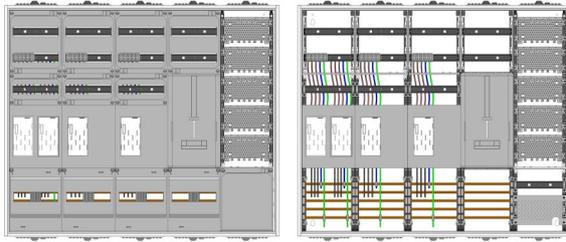
AEZ52-230-142, eHZ-Zählerverteilung nach VDE 0603, DIN43870, AR-N 4101:2015 für den Innenbereich für Wandbefestigung AP/UP, Fabr. Alphatec, BxHxT [mm] = 1300x1100x230, Schutzklasse II, IP54, RAL 7035, Bestehend aus: Gehäuse, Einzel- bzw. Doppeltür mit Drehriegel, Flansche SF45 (oben) und SF41 (unten) und Berührungsschutzabdeckungen, aufgebaut wie folgt: 4xZählerplatz, TSG, Verteilerfeld (12TE), APZ in Verteilerfeld, Verteilerfeld (12TE), komplett zusammengebaut und verdrahtet gemäß VNB.0123
