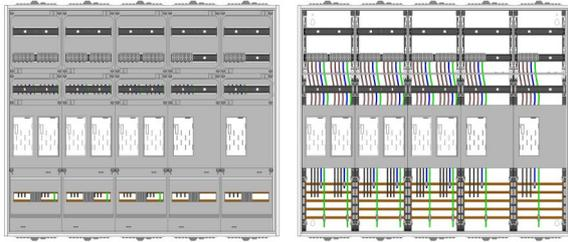
AEZ52-230-139, eHZ-Zählerverteilung nach VDE 0603, DIN43870, AR-N 4101:2015 für den Innenbereich für Wandbefestigung AP/UP, Fabr. Alphatec, BxHxT [mm] = 1300x1100x230, Schutzklasse II, IP54, RAL 7035, Bestehend aus: Gehäuse, Doppeltür mit Schwenkhebel für Profilhalbzylinder, Flansche SF45 (oben) und SF41 (unten) und Berührungsschutzabdeckungen, aufgebaut wie folgt: 8x Zählerplatz, 1x TSG-Platte, geeignet für TSG-Hutschienenmontage: ja, komplett zusammengebaut und verdrahtet gemäß VNB.0001
