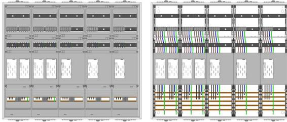
AEZ52-230-138, eHZ-Zählerverteilung nach VDE 0603, DIN43870, AR-N 4101:2015 für den Innenbereich für Wandbefestigung AP/UP, Fabr. Alphatec, BxHxT [mm] = 1300x1100x230, Schutzklasse II, IP54, RAL 7035, Bestehend aus: Gehäuse, Doppeltür mit Schwenkhebel für Profilhalbzylinder, Flansche SF45 (oben) und SF41 (unten) und Berührungsschutzabdeckungen, aufgebaut wie folgt: 7x Zählerplatz, 1x TSG-Platte, geeignet für TSG-Hutschienenmontage: ja, komplett zusammengebaut und verdrahtet gemäß VNB.0001
