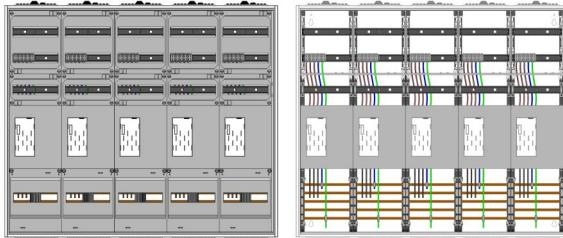
AEZ52-230-136, eHZ-Zählerverteilung nach VDE 0603, DIN43870, AR-N 4101:2015 für den Innenbereich für Wandbefestigung AP/UP, Fabr. Alphatec, BxHxT [mm] = 1300x1100x230, Schutzklasse II, IP54, RAL 7035, Bestehend aus: Gehäuse, Doppeltür mit Schwenkhebel für Profilhalbzylinder, Flansche SF45 (oben) und SF41 (unten) und Berührungsschutzabdeckungen, aufgebaut wie folgt: 5x Zählerplatz, 1x TSG-Platte, geeignet für TSG-Hutschienenmontage: ja, komplett zusammengebaut und verdrahtet gemäß VNB.0001
