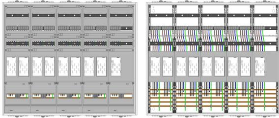
AEZ52-230-134, eHZ-Zählerverteilung nach VDE 0603, DIN43870, AR-N 4101:2015 für den Innenbereich für Wandbefestigung AP/UP, Fabr. Alphatec, BxHxT [mm] = 1300x1100x230, Schutzklasse II, IP54, RAL 7035, Bestehend aus: Gehäuse, Doppeltür mit Schwenkhebel für Profilhalbzylinder, Flansche SF45 (oben) und SF41 (unten) und Berührungsschutzabdeckungen, aufgebaut wie folgt: 9x Zählerplatz, komplett zusammengebaut und verdrahtet gemäß VNB.0001
