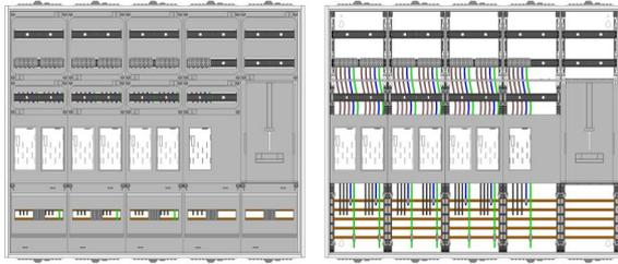
AEZ52-230-128, eHZ-Zählerverteilung nach VDE 0603, DIN43870, AR-N 4101:2015 für den Innenbereich für Wandbefestigung AP/UP, Fabr. Alphatec, BxHxT [mm] = 1300x1100x230, Schutzklasse II, IP54, RAL 7035, Bestehend aus: Gehäuse, Doppeltür mit Schwenkhebel für Profilhalbzylinder, Flansche SF45 (oben) und SF41 (unten) und Berührungsschutzabdeckungen, aufgebaut wie folgt: 7x Zählerplatz, 1x TSG-Platte, geeignet für TSG-Hutschienenmontage: nein, komplett zusammengebaut und verdrahtet gemäß VNB.0001
