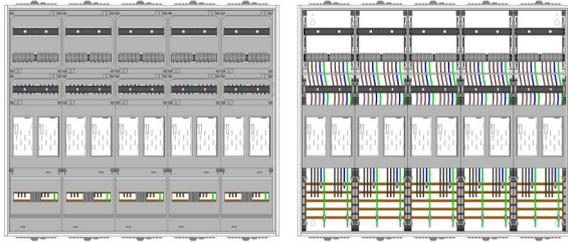
AEZ52-210-135, eHZ-Zählerverteilung nach VDE 0603, DIN43870, AR-N 4101:2015 für den Innenbereich für Wandbefestigung AP/UP, Fabr. Alphatec, BxHxT [mm] = 1300x1100x210, Schutzklasse II, IP41, RAL 9016, Bestehend aus: Gehäuse, Doppeltür mit Drehriegel, Flansche NF1 (oben) und NF2 (unten) und Berührungsschutzabdeckungen, aufgebaut wie folgt: 10x Zählerplatz, komplett zusammengebaut und verdrahtet gemäß VNB.0001
