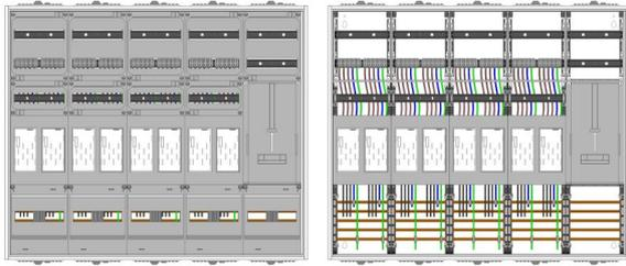
AEZ52-210-129, eHZ-Zählerverteilung nach VDE 0603, DIN43870, AR-N 4101:2015 für den Innenbereich für Wandbefestigung AP/UP, Fabr. Alphatec, BxHxT [mm] = 1300x1100x210, Schutzklasse II, IP41, RAL 9016, Bestehend aus: Gehäuse, Doppeltür mit Drehriegel, Flansche NF1 (oben) und NF2 (unten) und Berührungsschutzabdeckungen, aufgebaut wie folgt: 8x Zählerplatz, 1x TSG-Platte, geeignet für TSG-Hutschienenmontage: nein, komplett zusammengebaut und verdrahtet gemäß VNB.0001
