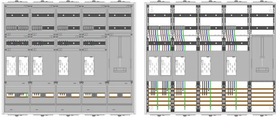
AEZ52-210-126, eHZ-Zählerverteilung nach VDE 0603, DIN43870, AR-N 4101:2015 für den Innenbereich für Wandbefestigung AP/UP, Fabr. Alphatec, BxHxT [mm] = 1300x1100x210, Schutzklasse II, IP41, RAL 9016, Bestehend aus: Gehäuse, Doppeltür mit Drehriegel, Flansche NF1 (oben) und NF2 (unten) und Berührungsschutzabdeckungen, aufgebaut wie folgt: 5x Zählerplatz, 1x TSG-Platte, geeignet für TSG-Hutschienenmontage: nein, komplett zusammengebaut und verdrahtet gemäß VNB.0001
