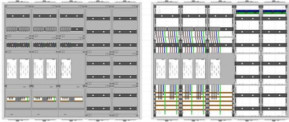
AEZ52-210-104, eHZ-Zählerverteilung nach VDE 0603, DIN43870, AR-N 4101:2015 für den Innenbereich für Wandbefestigung AP/UP, Fabr. Alphatec, BxHxT [mm] = 1300x1100x210, Schutzklasse II, IP41, RAL 9016, Bestehend aus: Gehäuse, Doppeltür mit Drehriegel, Flansche NF1 (oben) und NF2 (unten) und Berührungsschutzabdeckungen, aufgebaut wie folgt: 5x Zählerplatz, 7x Hutschienen in Verteilerfeld 1 (12TE), 7x Hutschienen in Verteilerfeld 2 (12TE), komplett zusammengebaut und verdrahtet gemäß VNB.0001
