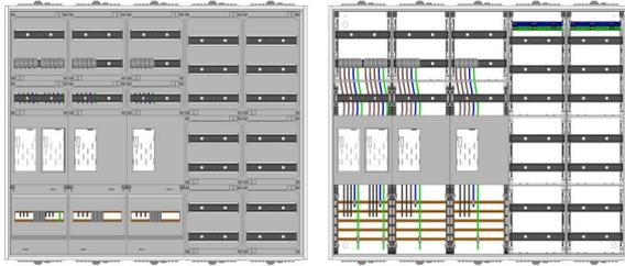
AEZ52-210-099, eHZ-Zählerverteilung nach VDE 0603, DIN43870, AR-N 4101:2015 für den Innenbereich für Wandbefestigung AP/UP, Fabr. Alphatec, BxHxT [mm] = 1300x1100x210, Schutzklasse II, IP41, RAL 9016, Bestehend aus: Gehäuse, Doppeltür mit Drehriegel, Flansche NF1 (oben) und NF2 (unten) und Berührungsschutzabdeckungen, aufgebaut wie folgt: 4x Zählerplatz, 7x Hutschienen in Verteilerfeld 1 (12TE), 7x Hutschienen in Verteilerfeld 2 (12TE), komplett zusammengebaut und verdrahtet gemäß VNB.0001
