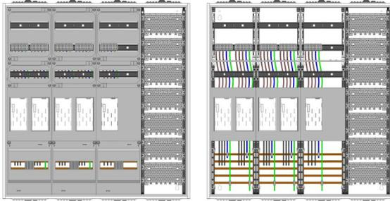
AEZ42-230-095, eHZ-Zählerverteilung nach VDE 0603, DIN43870, AR-N 4101:2015 für den Innenbereich für Wandbefestigung AP/UP, Fabr. Alphatec, BxHxT [mm] = 1050x1100x230, Schutzklasse II, IP54, RAL 7035, Bestehend aus: Gehäuse, Einzel- bzw. Doppeltür mit Drehriegel, Flansche SF45 (oben) und SF41 (unten) und Berührungsschutzabdeckungen, aufgebaut wie folgt: 5xZählerplatz, Medienfeld, externer APZ erforderlich, geeignet für TSG Hutschienenmontage, komplett zusammengebaut und verdrahtet gemäß VNB.0120
