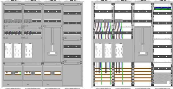
AEZ42-230-084, eHZ-Zählerverteilung nach VDE 0603, DIN43870, AR-N 4101:2015 für den Innenbereich für Wandbefestigung AP/UP, Fabr. Alphatec, BxHxT [mm] = 1050x1100x230, Schutzklasse II, IP54, RAL 7035, Bestehend aus: Gehäuse, Einzel- bzw. Doppeltür mit Drehriegel, Flansche SF45 (oben) und SF41 (unten) und Berührungsschutzabdeckungen, aufgebaut wie folgt: 3xZählerplatz, TSG, Verteilerfeld (12TE), APZ in Verteilerfeld, Verteilerfeld (12TE), komplett zusammengebaut und verdrahtet gemäß VNB.0109
