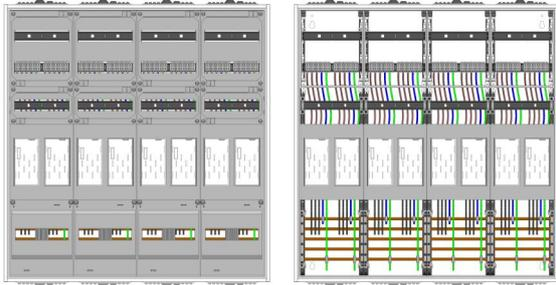
AEZ42-230-080, eHZ-Zählerverteilung nach VDE 0603, DIN43870, AR-N 4101:2015 für den Innenbereich für Wandbefestigung AP/UP, Fabr. Alphatec, BxHxT [mm] = 1050x1100x230, Schutzklasse II, IP54, RAL 7035, Bestehend aus: Gehäuse, Doppeltür mit Schwenkhebel für Profilhalbzylinder, Flansche SF45 (oben) und SF41 (unten) und Berührungsschutzabdeckungen, aufgebaut wie folgt: 8x Zählerplatz, komplett zusammengebaut und verdrahtet gemäß VNB.0001
