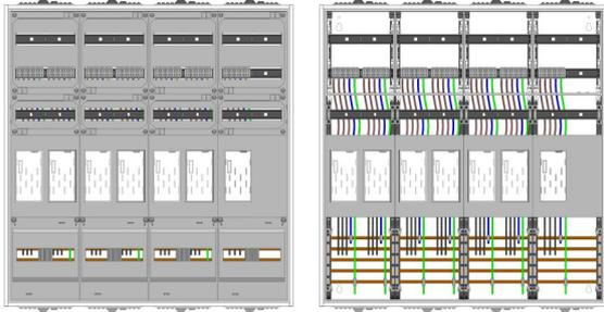
AEZ42-230-078, eHZ-Zählerverteilung nach VDE 0603, DIN43870, AR-N 4101:2015 für den Innenbereich für Wandbefestigung AP/UP, Fabr. Alphatec, BxHxT [mm] = 1050x1100x230, Schutzklasse II, IP54, RAL 7035, Bestehend aus: Gehäuse, Doppeltür mit Schwenkhebel für Profilhalbzylinder, Flansche SF45 (oben) und SF41 (unten) und Berührungsschutzabdeckungen, aufgebaut wie folgt: 7x Zählerplatz, komplett zusammengebaut und verdrahtet gemäß VNB.0001
