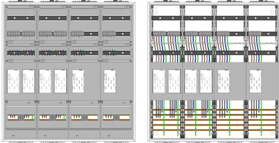
AEZ42-230-077, eHZ-Zählerverteilung nach VDE 0603, DIN43870, AR-N 4101:2015 für den Innenbereich für Wandbefestigung AP/UP, Fabr. Alphatec, BxHxT [mm] = 1050x1100x230, Schutzklasse II, IP54, RAL 7035, Bestehend aus: Gehäuse, Doppeltür mit Schwenkhebel für Profilhalbzylinder, Flansche SF45 (oben) und SF41 (unten) und Berührungsschutzabdeckungen, aufgebaut wie folgt: 6x Zählerplatz, 1x TSG-Platte, geeignet für TSG-Hutschienenmontage: ja, komplett zusammengebaut und verdrahtet gemäß VNB.0001
