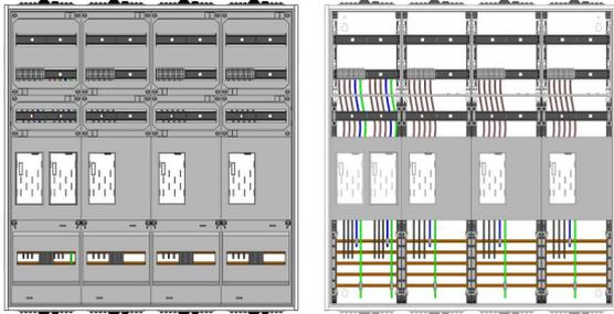
AEZ42-230-073, eHZ-Zählerverteilung nach VDE 0603, DIN43870, AR-N 4101:2015 für den Innenbereich für Wandbefestigung AP/UP, Fabr. Alphatec, BxHxT [mm] = 1050x1100x230, Schutzklasse II, IP54, RAL 7035, Bestehend aus: Gehäuse, Doppeltür mit Schwenkhebel für Profilhalbzylinder, Flansche SF45 (oben) und SF41 (unten) und Berührungsschutzabdeckungen, aufgebaut wie folgt: 4x Zählerplatz, 1x TSG-Platte, geeignet für TSG-Hutschienenmontage: ja, komplett zusammengebaut und verdrahtet gemäß VNB.0001
