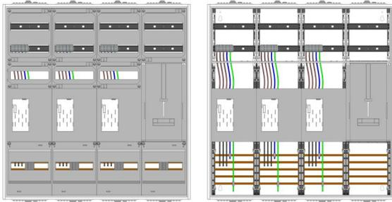
AEZ42-230-068, eHZ-Zählerverteilung nach VDE 0603, DIN43870, AR-N 4101:2015 für den Innenbereich für Wandbefestigung AP/UP, Fabr. Alphatec, BxHxT [mm] = 1050x1100x230, Schutzklasse II, IP54, RAL 7035, Bestehend aus: Gehäuse, Doppeltür mit Schwenkhebel für Profilhalbzylinder, Flansche SF45 (oben) und SF41 (unten) und Berührungsschutzabdeckungen, aufgebaut wie folgt: 3x Zählerplatz, 1x TSG-Platte, geeignet für TSG-Hutschienenmontage: nein, komplett zusammengebaut und verdrahtet gemäß VNB.0001
