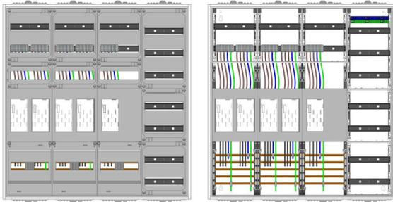
AEZ42-230-062, eHZ-Zählerverteilung nach VDE 0603, DIN43870, AR-N 4101:2015 für den Innenbereich für Wandbefestigung AP/UP, Fabr. Alphatec, BxHxT [mm] = 1050x1100x230, Schutzklasse II, IP54, RAL 7035, Bestehend aus: Gehäuse, Doppeltür mit Schwenkhebel für Profilhalbzylinder, Flansche SF45 (oben) und SF41 (unten) und Berührungsschutzabdeckungen, aufgebaut wie folgt: 5x Zählerplatz, 7x Hutschienen in Verteilerfeld 1 (12TE), komplett zusammengebaut und verdrahtet gemäß VNB.0001
