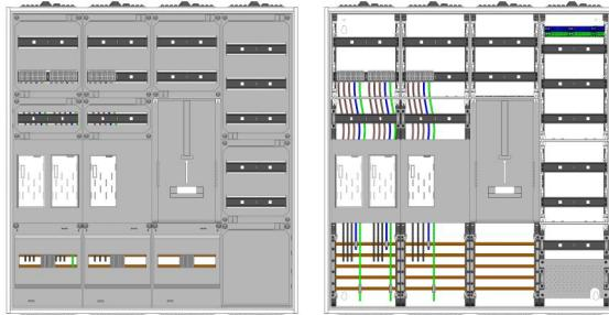
AEZ42-210-084, eHZ-Zählerverteilung nach VDE 0603, DIN43870, AR-N 4101:2015 für den Innenbereich für Wandbefestigung AP/UP, Fabr. Alphatec, BxHxT [mm] = 1050x1100x210, Schutzklasse II, IP41, RAL 9016, Bestehend aus: Gehäuse, Einzel- bzw. Doppeltür mit Drehriegel, Flansche NF1 (oben) und NF2 (unten) und Berührungsschutzabdeckungen, aufgebaut wie folgt: 3xZählerplatz, TSG, Verteilerfeld (12TE), APZ in Verteilerfeld, komplett zusammengebaut und verdrahtet gemäß VNB.0021
