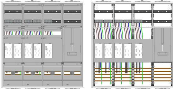
AEZ42-210-070, eHZ-Zählerverteilung nach VDE 0603, DIN43870, AR-N 4101:2015 für den Innenbereich für Wandbefestigung AP/UP, Fabr. Alphatec, BxHxT [mm] = 1050x1100x210, Schutzklasse II, IP41, RAL 9016, Bestehend aus: Gehäuse, Doppeltür mit Drehriegel, Flansche NF1 (oben) und NF2 (unten) und Berührungsschutzabdeckungen, aufgebaut wie folgt: 5x Zählerplatz, 1x TSG-Platte, geeignet für TSG-Hutschienenmontage: nein, komplett zusammengebaut und verdrahtet gemäß VNB.0001
