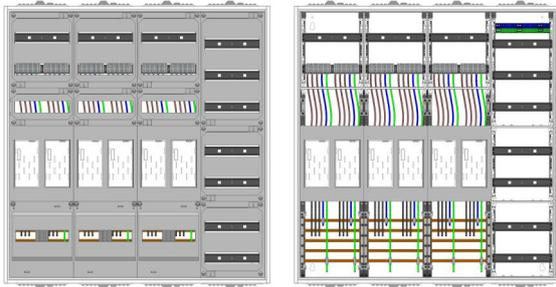
AEZ42-210-066, eHZ-Zählerverteilung nach VDE 0603, DIN43870, AR-N 4101:2015 für den Innenbereich für Wandbefestigung AP/UP, Fabr. Alphatec, BxHxT [mm] = 1050x1100x210, Schutzklasse II, IP41, RAL 9016, Bestehend aus: Gehäuse, Doppeltür mit Drehriegel, Flansche NF1 (oben) und NF2 (unten) und Berührungsschutzabdeckungen, aufgebaut wie folgt: 6x Zählerplatz, 7x Hutschienen in Verteilerfeld 1 (12TE), komplett zusammengebaut und verdrahtet gemäß VNB.0001
