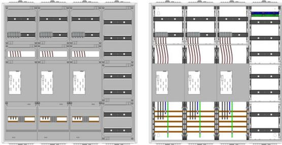
AEZ42-210-054, eHZ-Zählerverteilung nach VDE 0603, DIN43870, AR-N 4101:2015 für den Innenbereich für Wandbefestigung AP/UP, Fabr. Alphatec, BxHxT [mm] = 1050x1100x210, Schutzklasse II, IP41, RAL 9016, Bestehend aus: Gehäuse, Doppeltür mit Drehriegel, Flansche NF1 (oben) und NF2 (unten) und Berührungsschutzabdeckungen, aufgebaut wie folgt: 3x Zählerplatz, 7x Hutschienen in Verteilerfeld 1 (12TE), komplett zusammengebaut und verdrahtet gemäß VNB.0001
