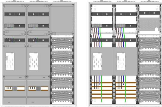
AEZ32-230-045, eHZ-Zählerverteilung nach VDE 0603, DIN43870, AR-N 4101:2015 für den Innenbereich für Wandbefestigung AP/UP, Fabr. Alphatec, BxHxT [mm] = 800x1100x230, Schutzklasse II, IP54, RAL 7035, Bestehend aus: Gehäuse, Einzel- bzw. Doppeltür mit Drehriegel, Flansche SF45 (oben) und SF41 (unten) und Berührungsschutzabdeckungen, aufgebaut wie folgt: 2xZählerplatz, TSG, APZ in Medienfeld, geeignet für TSG Hutschienenmontage, komplett zusammengebaut und verdrahtet gemäß VNB.0103
