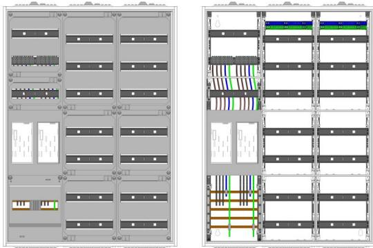
AEZ32-210-018, eHZ-Zählerverteilung nach VDE 0603, DIN43870, AR-N 4101:2015 für den Innenbereich für Wandbefestigung AP/UP, Fabr. Alphatec, BxHxT [mm] = 800x1100x210, Schutzklasse II, IP41, RAL 9016, Bestehend aus: Gehäuse, Doppeltür mit Drehriegel, Flansche NF1 (oben) und NF2 (unten) und Berührungsschutzabdeckungen, aufgebaut wie folgt: 2x Zählerplatz, 7x Hutschienen in Verteilerfeld 1 (12TE), 7x Hutschienen in Verteilerfeld 2 (12TE), komplett zusammengebaut und verdrahtet gemäß VNB.0001
