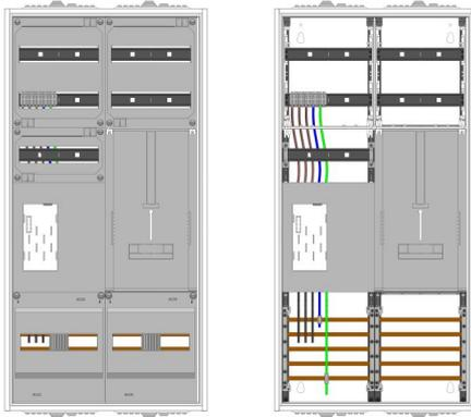
AEZ22-230-018, eHZ-Zählerverteilung nach VDE 0603, DIN43870, AR-N 4101:2015 für den Innenbereich für Wandbefestigung AP/UP, Fabr. Alphatec, BxHxT [mm] = 550x1100x230, Schutzklasse II, IP54, RAL 7035, Bestehend aus: Gehäuse, Einzel- bzw. Doppeltür mit Drehriegel, Flansche SF45 (oben) und SF41 (unten) und Berührungsschutzabdeckungen, aufgebaut wie folgt: 1xZählerplatz, TSG, externer APZ erforderlich, komplett zusammengebaut und verdrahtet gemäß VNB.0096
