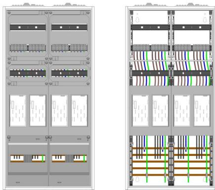
AEZ22-230-005, eHZ-Zählerverteilung nach VDE 0603, DIN43870, AR-N 4101:2015 für den Innenbereich für Wandbefestigung AP/UP, Fabr. Alphatec, BxHxT [mm] = 550x1100x230, Schutzklasse II, IP54, RAL 7035, Bestehend aus: Gehäuse, Einzeltür mit Schwenkhebel für Profilhalbzylinder, Flansche SF45 (oben) und SF41 (unten) und Berührungsschutzabdeckungen, aufgebaut wie folgt: 4x Zählerplatz, komplett zusammengebaut und verdrahtet gemäß VNB.0001
