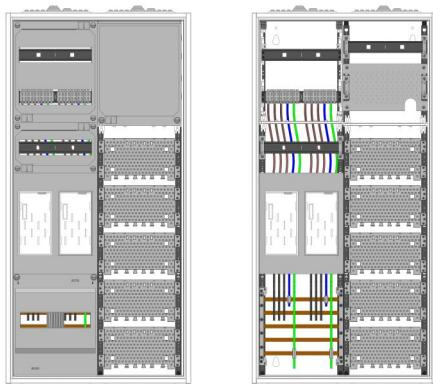
AEZ22-210-014, eHZ-Zählerverteilung nach VDE 0603, DIN43870, AR-N 4101:2015 für den Innenbereich für Wandbefestigung AP/UP, Fabr. Alphatec, BxHxT [mm] = 550x1100x210, Schutzklasse II, IP41, RAL 9016, Bestehend aus: Gehäuse, Einzel- bzw. Doppeltür mit Drehriegel, Flansche NF1 (oben) und NF2 (unten) und Berührungsschutzabdeckungen, aufgebaut wie folgt: 2xZählerplatz, TSG, APZ in Medienfeld, geeignet für TSG Hutschienenmontage, komplett zusammengebaut und verdrahtet gemäß VNB.0004
