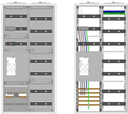
AEZ22-210-010, eHZ-Zählerverteilung nach VDE 0603, DIN43870, AR-N 4101:2015 für den Innenbereich für Wandbefestigung AP/UP, Fabr. Alphatec, BxHxT [mm] = 550x1100x210, Schutzklasse II, IP41, RAL 9016, Bestehend aus: Gehäuse, Einzeltür mit Drehriegel, Flansche NF1 (oben) und NF2 (unten) und Berührungsschutzabdeckungen, aufgebaut wie folgt: 1x Zählerplatz, 7x Hutschienen in Verteilerfeld 1 (12TE), komplett zusammengebaut und verdrahtet gemäß VNB.0001
